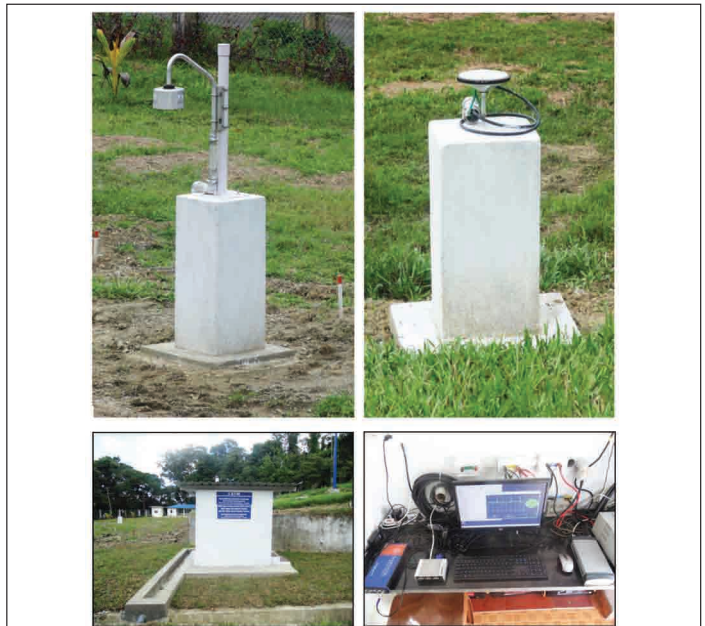
आकृति 33 चूं.वे., सिलचर में AEFM एवं GNSS रिसीवर फील्ड स्थापन।
